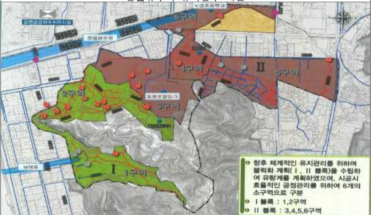
보덕포 상류 분류식 하수관로 설치
