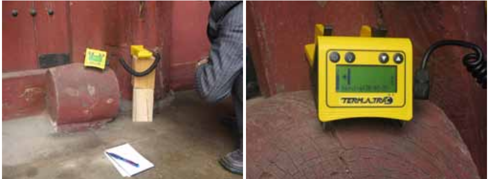
극초음파탐지장비를 이용한 기동 조사 모습 (호주, Termatrac 社)
